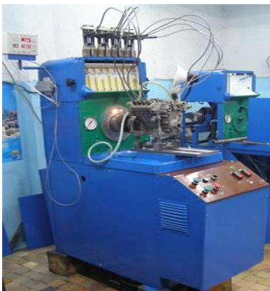
**Рисунок 2 - Общий вид стенда для ускоренных износных испытаний**
