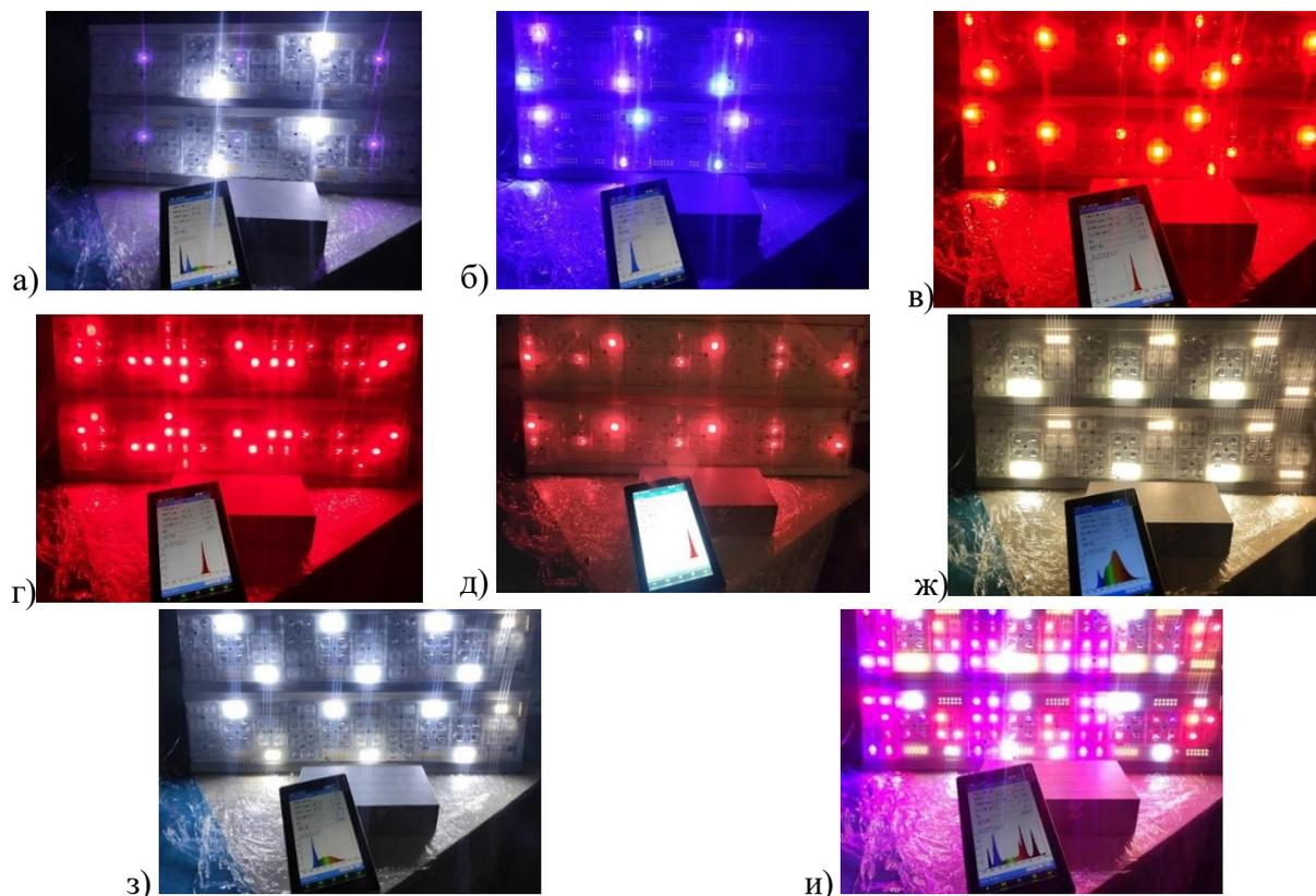
Рисунок 4 – Режимы излучения: а)  $\lambda=380$  нм; б)  $\lambda=440, 465$  нм; в)  $\lambda=630$  нм; г)  $\lambda=660$  нм; д)  $\lambda=730$  нм; ж)  $T_c=2700$  К; з)  $T_c=6500$  К; и) полный спектр
