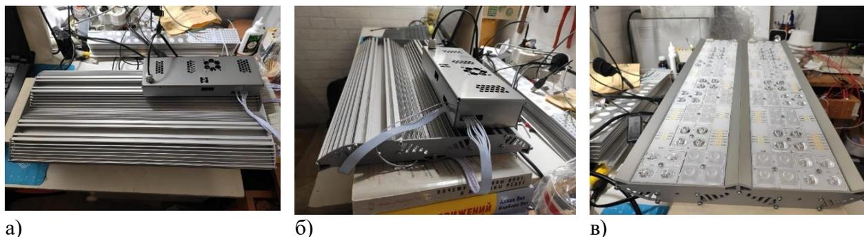
Рисунок 3 – Семиканальный светодиодный фитоизлучатель:
