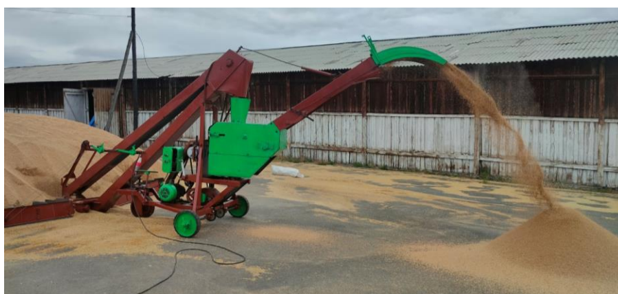
Рисунок 3 – Восстановленный ЗМ-60 в процессе работы
