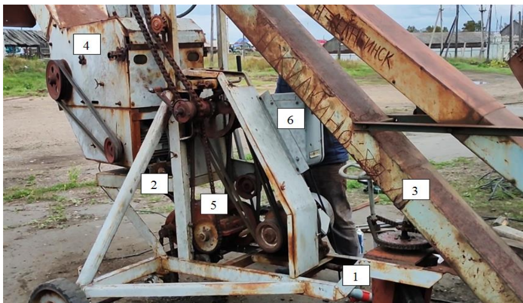
Рисунок 1 – Внешний вид и конструкция ЗМ-60 до проведения ТО и ремонта
