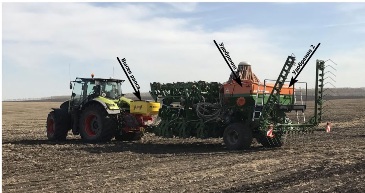
Рисунок 1 – Посевной агрегат AMAZONE Primera DMC 9000-2С с бункером APV PS 800
