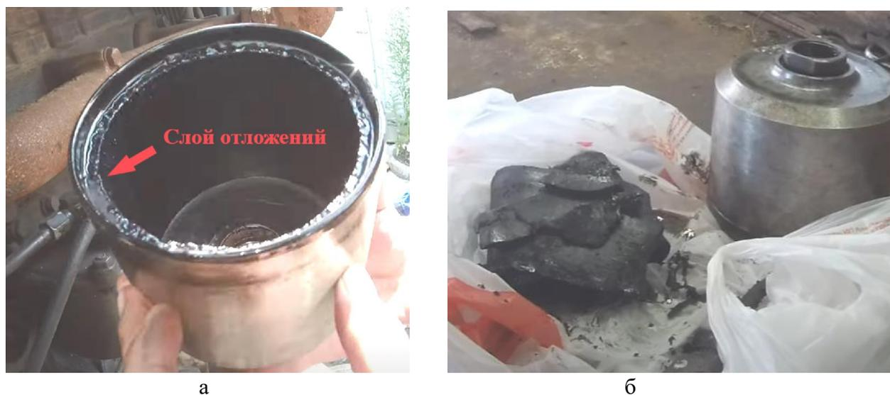
Рисунок 2 – Накопление отложений в роторе центробежного маслоочистителя (а) и их внешний вид на фоне ротора (б)
