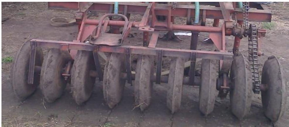
Рисунок 2 – Переоборудованная сеялка СЗС- 2.1
