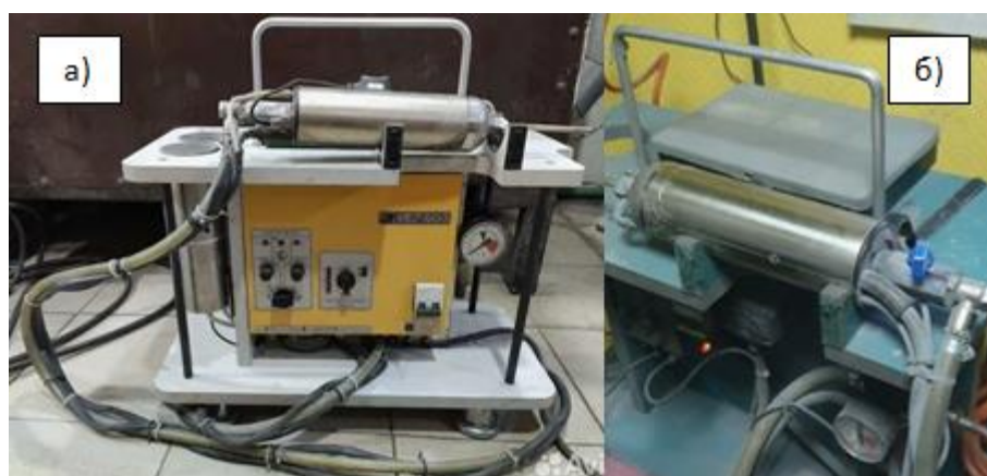
Рисунок 2 – Приборы для холодного газодинамического напыления а) прибор “Димет-405”; б) прибор “Димет-412”
