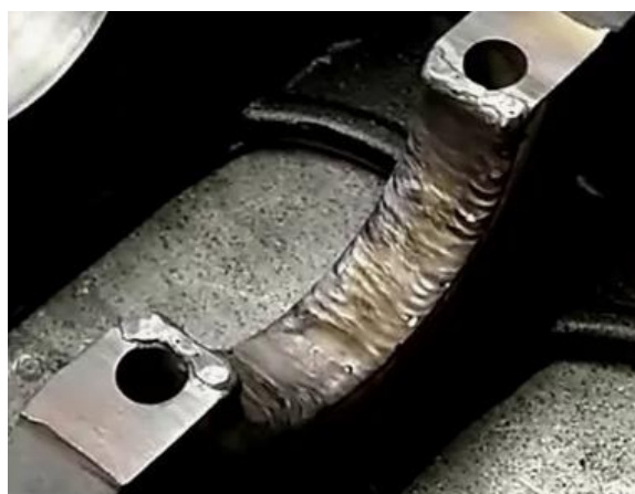
Рисунок 3 – Устранение трещины пастели блока цилиндров напылением
