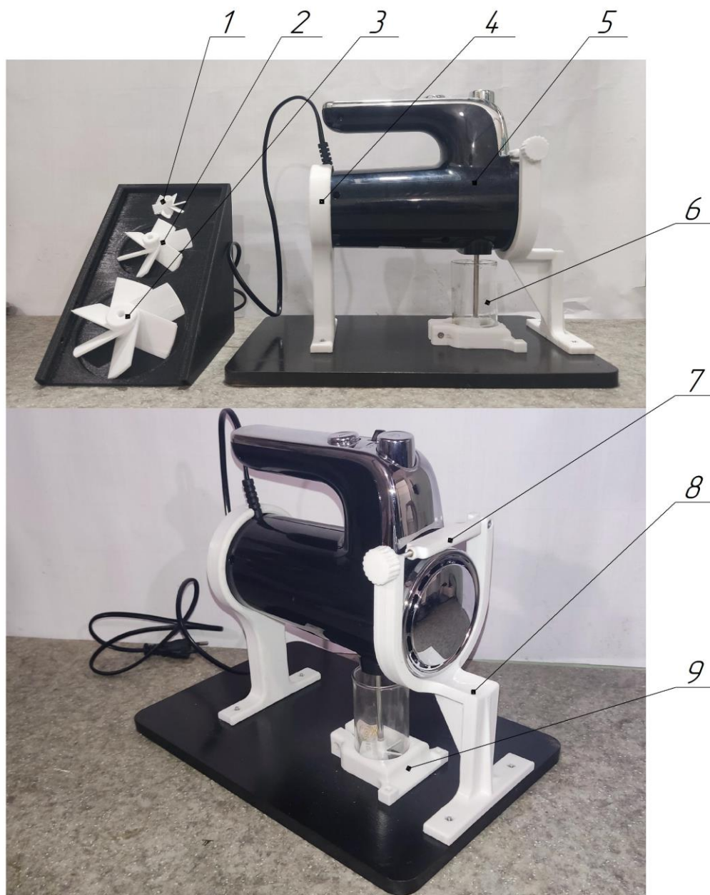
Рисунок – Аппарат с турбинными мешалками трех типоразмеров: 1, 2, 3 – турбинные мешалки различных типоразмеров с наклонными лопатками полной длины; 4 – задняя стойка; 5 – привод, миксер DEXP; 6 – емкость для раствора нанокompозита; 7 – зажим; 8 – передняя стойка; 9 – фиксатор ёмкости [5]
