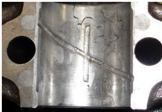
Рисунок 2 – Подшипник с нанесенным внутренним рабочим слоем (Cummins QSM-11 Buhler Versatile 2375) [8]
