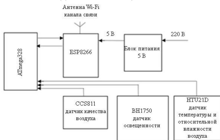
Рисунок 1 – Функциональная схема устройства для сбора, хранения и передачи данных микроклиматических (температура, влажность) и физических (газовый состав, освещенность) параметров в животноводческих помещениях с применением технологий интернета вещей (IoT)
