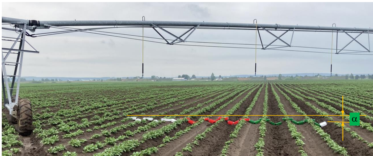
Рисунок 3 – Фрагмент дождевальной машины с набором дождевателей и измерительных кювет на орошаемой поверхности
