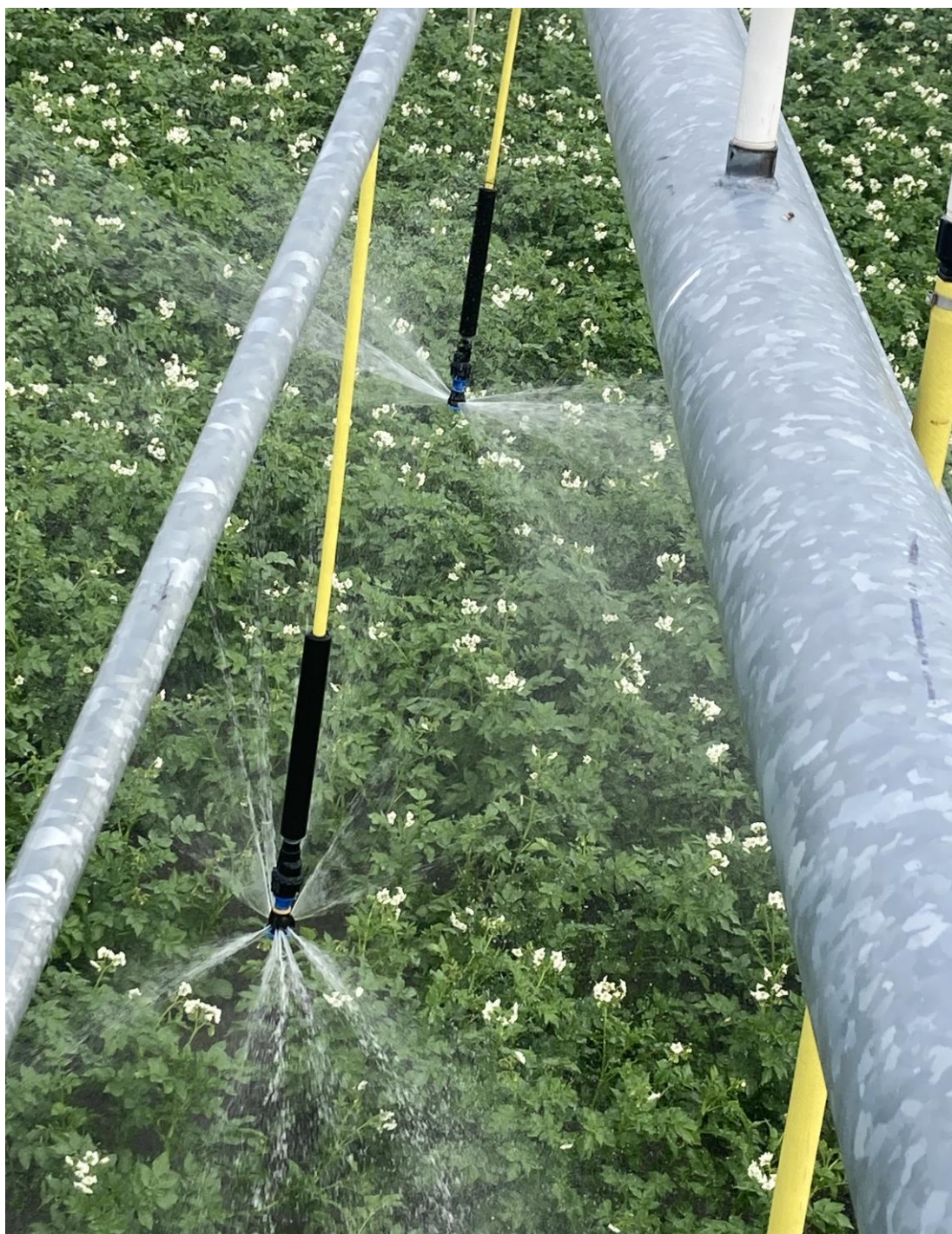
Рисунок 1 – Веерообразные струи воды за кромкой рассекателя дождевателя серии D3000 с одним держателем сопла
