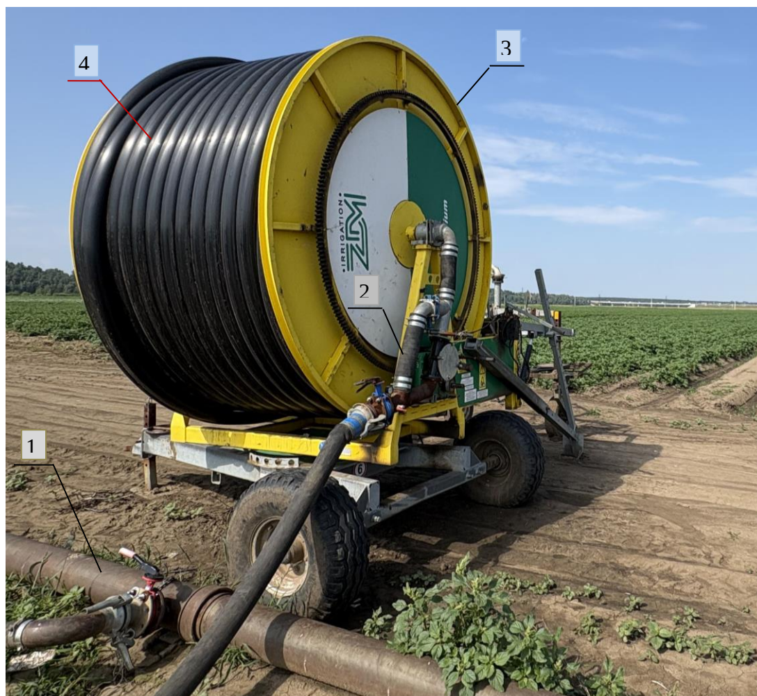
Рисунок 1 – Фотография общего вида дождевальной машины ZDM барабанного типа 500/110 с дальноструйным дождевателем
